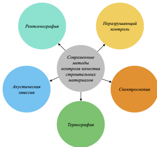
Рисунок 3 - Современные методы контроля качества строительных материалов
