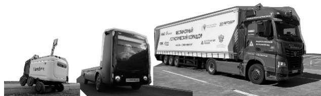
Рис. 1. Примеры отечественных беспилотных автомобилей разного типа: робот-курьер Яндекс, малотоннажный грузовик Эво-каро, крупнотоннажный грузовик КамАЗ.
